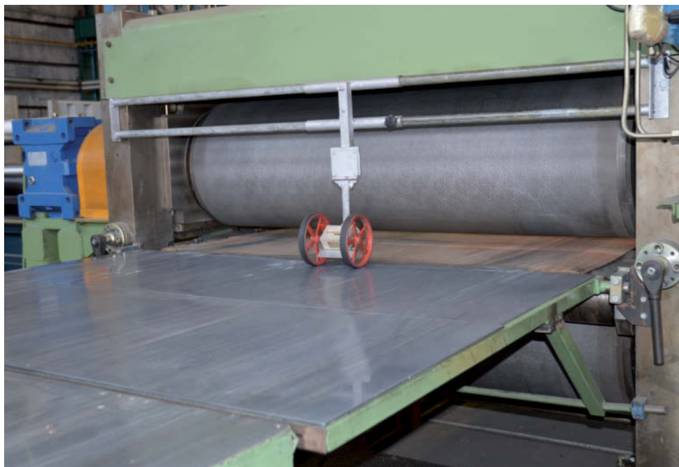
Dettaglio impianto di goffratura presente all'interno del proprio ciclo produttivo di Alusteel Coating.
